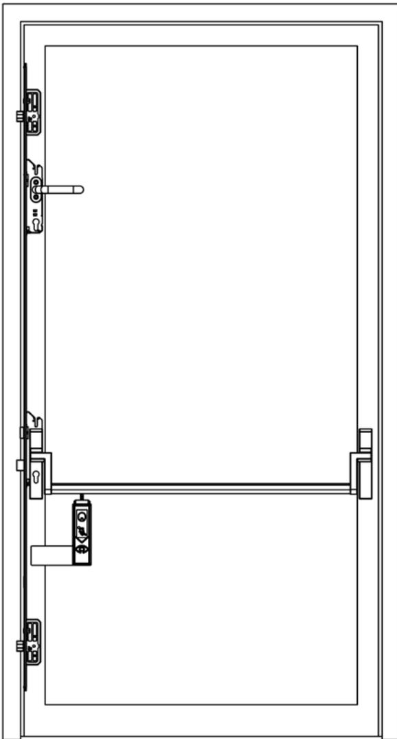
**Panik-Griffstange mit geprüftem und zugelassenem Türwächter, z.B. GfS, gemäß Zertifikat EN 1125, siehe [www.fuhr.de](http://www.fuhr.de)**
