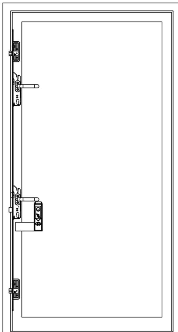
Drücker mit geprüftem und zugelassenem Türwächter, z.B. GfS, gemäß Zertifikat EN 179, siehe [www.fuhr.de](http://www.fuhr.de)
