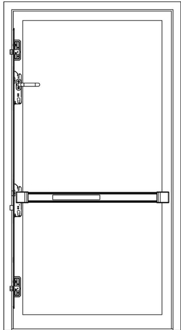
**Geprüfte und zugelassene Panik-Druckstange mit Türalarm, z.B. GfS, gemäß Zertifikat EN 1125, siehe [www.fuhr.de](http://www.fuhr.de)**
